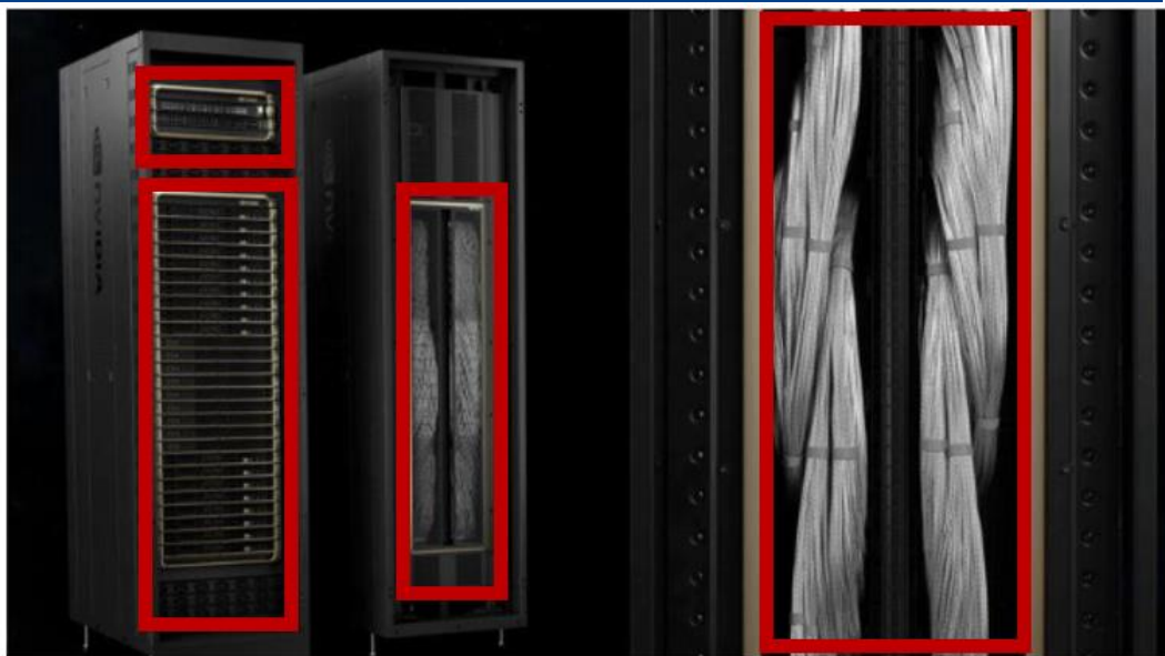
图表 7：NVL72 机柜背部密集的线背板互联
