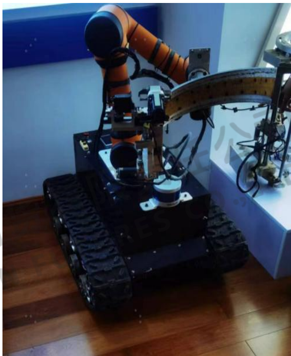
图：可移动的“一机多树”割胶机器人
