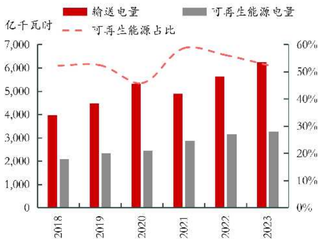
图表 24：20 条直流特高压线路输电情况
