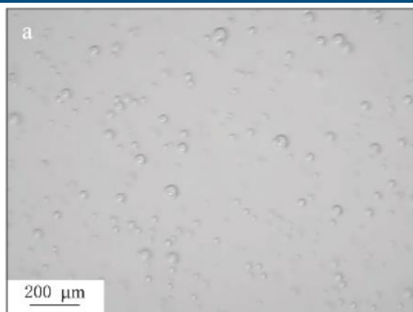
图表 28：石英坩埚内层平面照片（气泡较少）
