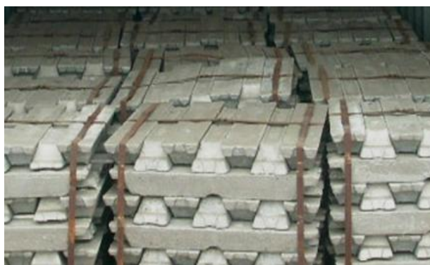
图 4：再生铸造铝合金锭
