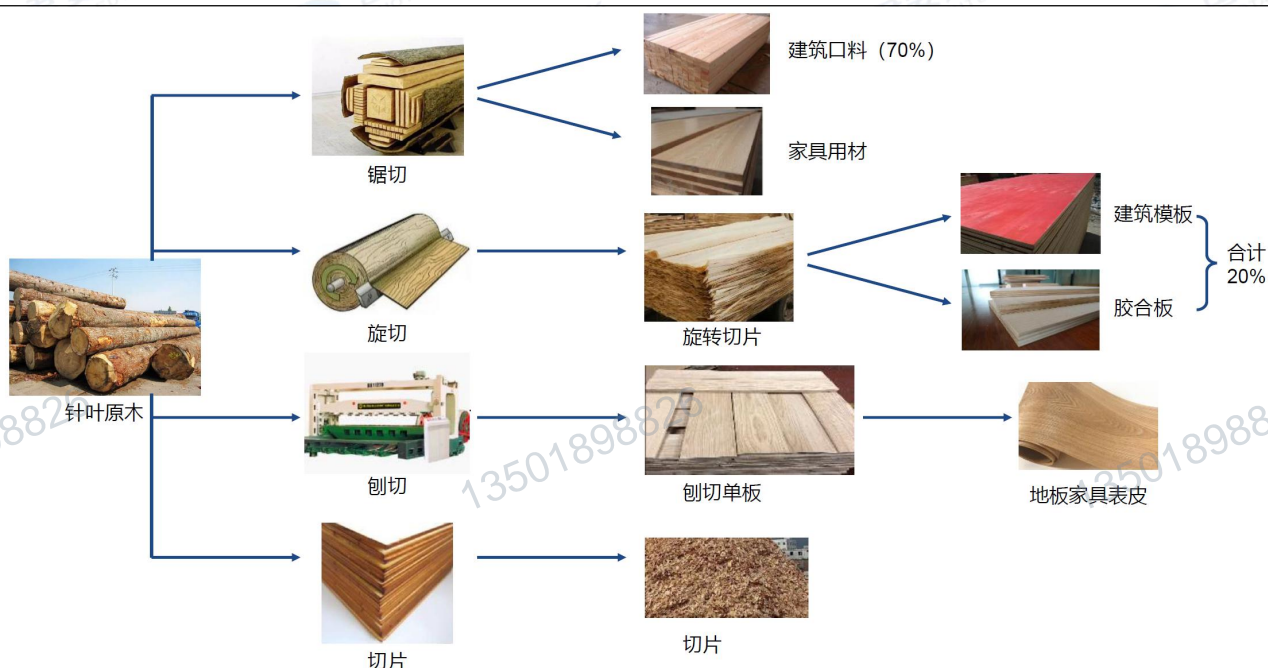
图 3：原木的四类主要加工方式：锯切、旋切、刨切和切片，及下游产业链
