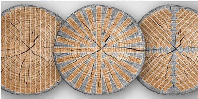
图 1：由左到右依次为弦切、四分切、裂缝切，灰色部分为各加工过程中产生的废料
