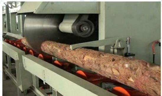
图 2：横向锯切示意图：将原木锯成短段，可以避免原木弯曲和开裂的部分
