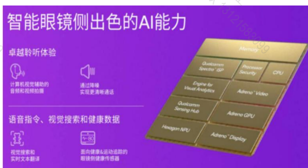
图表7: 高通 AR1 Gen1 可支持智能眼镜上部署端侧模型
