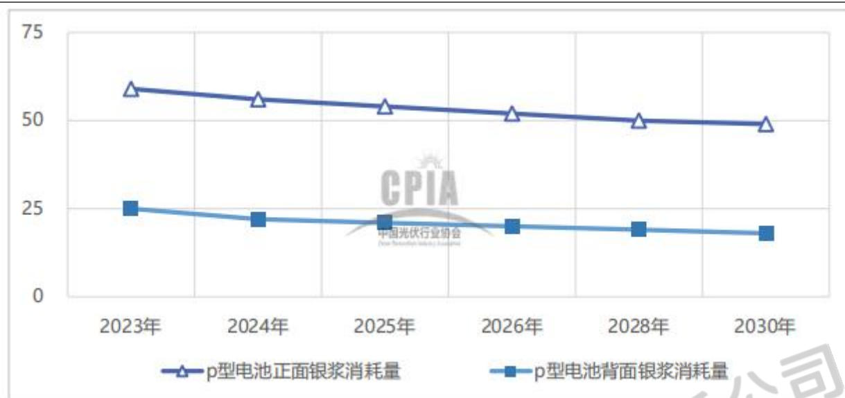
图：2023-2030 年 p 型电池片正/背面银浆消耗量变化趋势（单位：mg/片）
