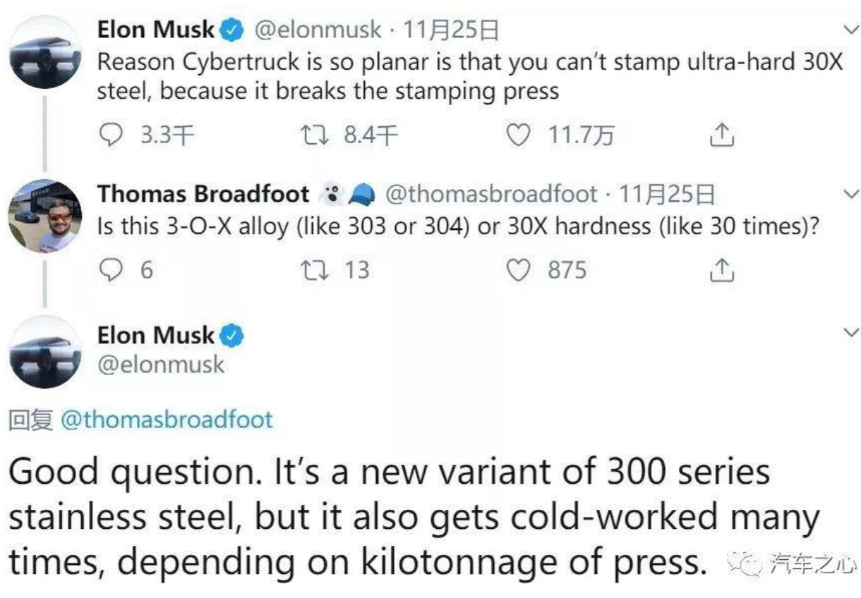
图 3：马斯克表示“30X”代表 300 系不锈钢而非 30 倍硬度
