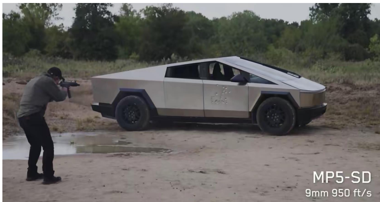
图 2：30X 冷轧不锈钢防弹测试
