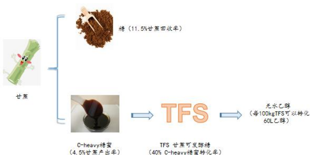
图表 3：C-heavy 糖蜜作原材料制乙醇工艺流程
