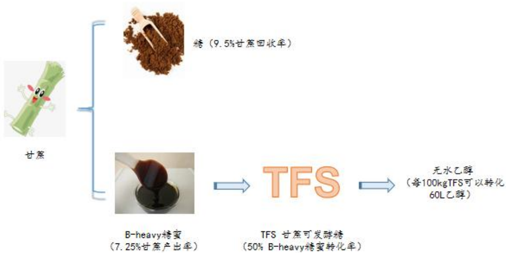
图表 1：B-heavy 糖蜜作原材料制乙醇工艺流程
