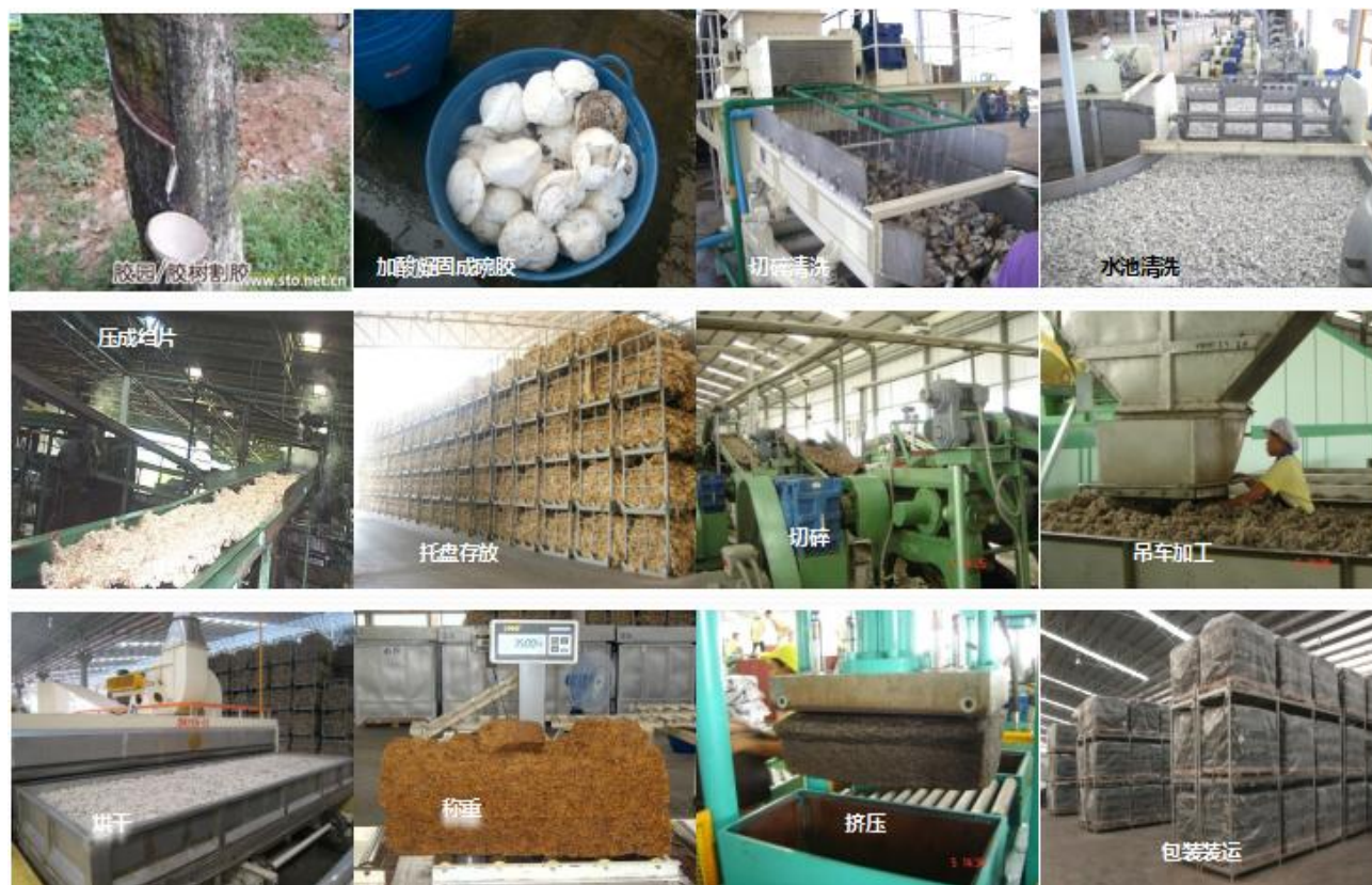
图 2 20 号标准胶生产工艺全过程
