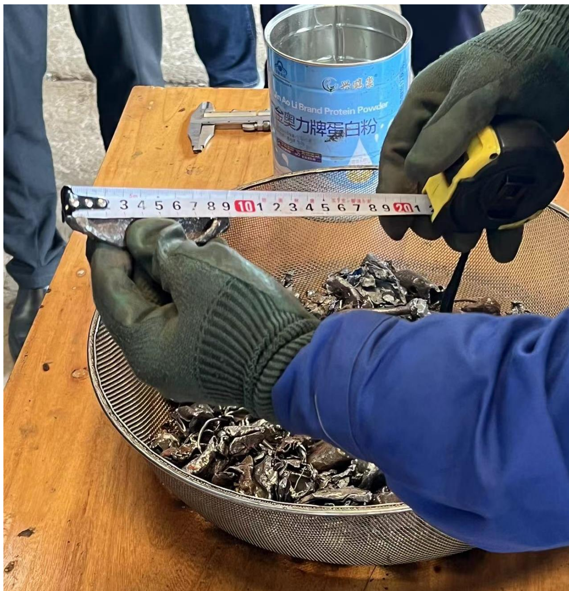
图表 5：样品夹杂物含量检测
