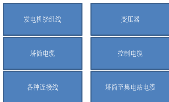
图表 45 风电用铜结构
