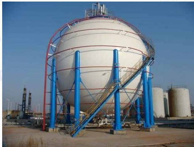
图 18：丁二烯大型储罐（1000、1500 立方米）
