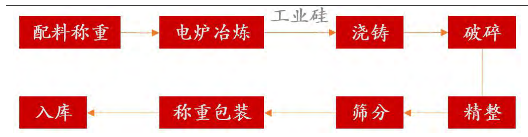
图表 7：工业硅生产流程
