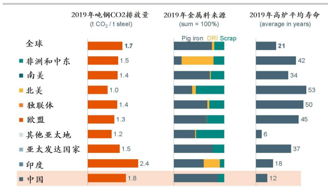
图 6：主要国家和地区吨钢二氧化碳排放量、金属料来源以及高炉寿命对比
